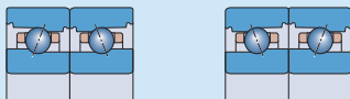
Rigidzza assiale statica per due cuscinetti in disposizione a "O" oppure a "X" – serie 719 .. B
